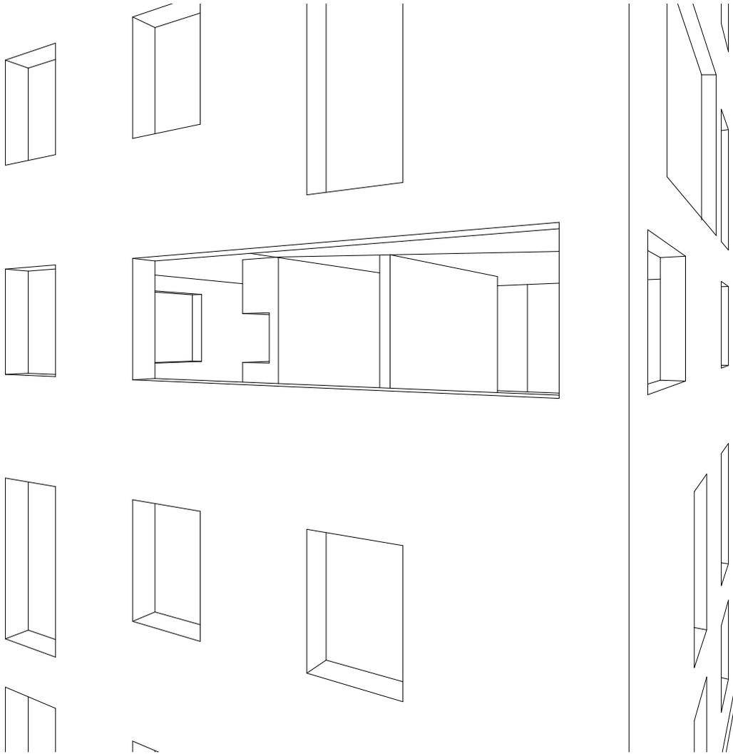
top 22 verkleinert den zu beheizenden raum indem die dämmung an eingezogene innenwände verlagert wird. gleichzeitig bietet sich so die möglichkeit von grossen, einfachverglasten öffnungen in der fassade.
